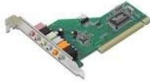
*También llamadas tarjeta de audio, es un dispositivo (tarjeta de circuitos impresos) que le da a la computadora la habilidad de producir sonidos. Es la tarjeta con más clavijas y posibilidades de conexión, para las bocinas (Line out o Speaker out), CD-ROM, estéreo (Line in), micrófono (Mic. In). Contiene componentes que permite convertir el lenguaje de la computadora en sonidos y viceversa. Las bocinas o los audífonos permiten oír los sonidos producidos por la tarjeta de sonido.*
